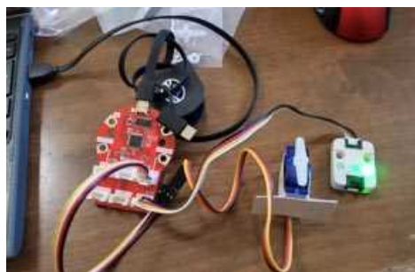
AkaDako キットにLEDやモーターを接続してプログラムで動かす
